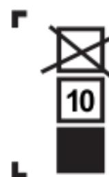
Índica a quantidade máxima de caixas que podem ser empilhadas no transporte e armazenamento.
