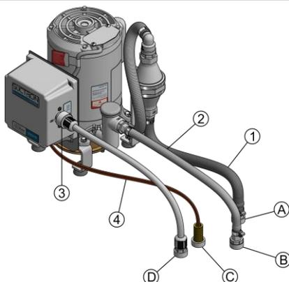
Rosquear a entrada de água de 1/2" na espera (ponto "D"- Água) rente ao piso e a de 3/4" na conexão de "Entrada Água" (Nº 3) na SUCTRON.
